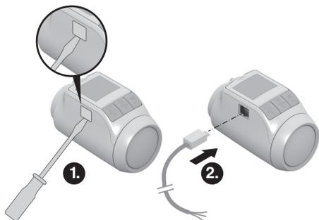
1. Se detașează capacul lateral de pe capul termostatic.
