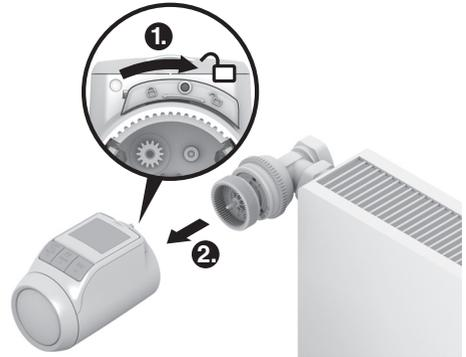
1. Se deblochează capul termostatic. Pentru aceasta se împinge zăvorul de pe capul termostatic în direcția
