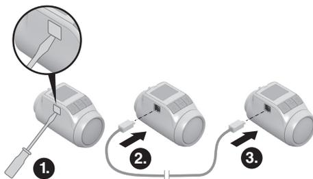
1. Se detașează capacul lateral de pe toate capetele termostatic electronice.
